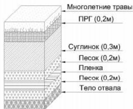
Рисунок 3.1. Схемы устройства противofильтрационных экранов Технико-экономическое сравнение вариантов укладки противofильтрационного экрана приведено в таблице 3.4.
